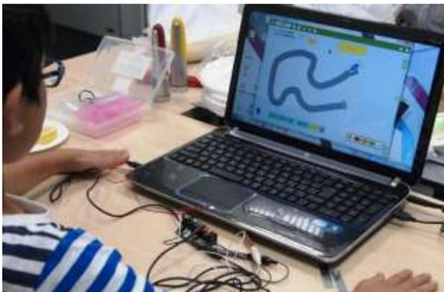
電圧を車の速度に変換するプログラムを開発
